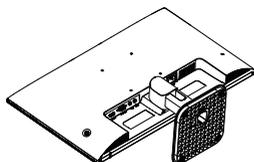
2. 固定クリップを押して、ベーススタンドをベース支柱から取り外します。
