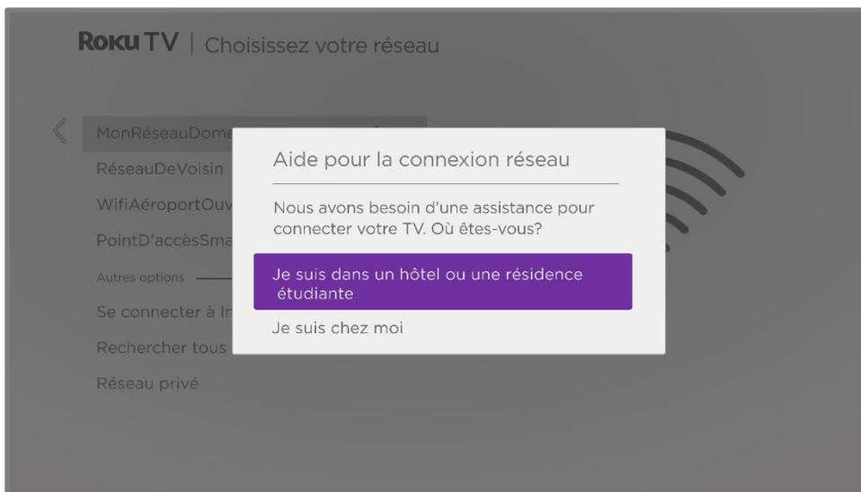
**Astuce :** *Votre téléviseur ne peut se connecter à un réseau restreint que si **Activer « Connexion de l'appareil »** est sélectionné dans **Paramètres > Système > Paramètres systèmes avancés**. L'option **Connexion de l'appareil** est activée par défaut, mais si vous l'avez désactivée, le téléviseur ne peut pas procéder à la connexion.*
