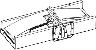
2. Afloje los tornillos de montaje y, a continuación, extraiga el soporte del monitor.
