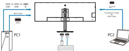
2. Rufen Sie das OSD-Menü auf. Rufen Sie das KVM-Register auf und wechseln Sie zum Umschalten der Monitoransicht von dem einen auf ein anderes Gerät „Auto“, „Thunderbolt“ oder „USB C“. Zum Umschalten zur anderen Monitoransicht wiederholen Sie diesen Schritt einfach.
