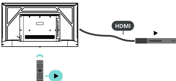
HDMI CEC (del inglés *Consumer Electronic Control*, control electrónico del consumidor) debe estar encendido en el televisor y en el dispositivo conectado.
