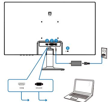
١ دخل طاقة التيار المتردد/التيار المستمر
