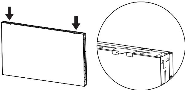
3. Installare con cura il display superiore. Una volta montati i display, assicurarsi di lasciare abbastanza spazio tra i display per rimuovere il pad di riempimento. Se il pad è difficile da rimuovere, regolare la posizione del display per ottenere spazio sufficiente.
