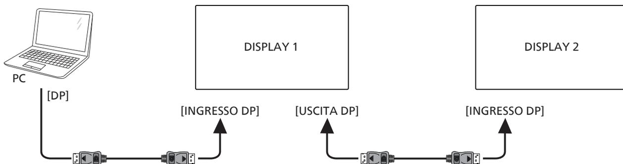
Collegare da [DVI] a [INGRESSO DVI] del laptop di DISPLAY 1, collegare il connettore [USCITA DP] di DISPLAY 1 al connettore [INGRESSO DP] di DISPLAY 2.
