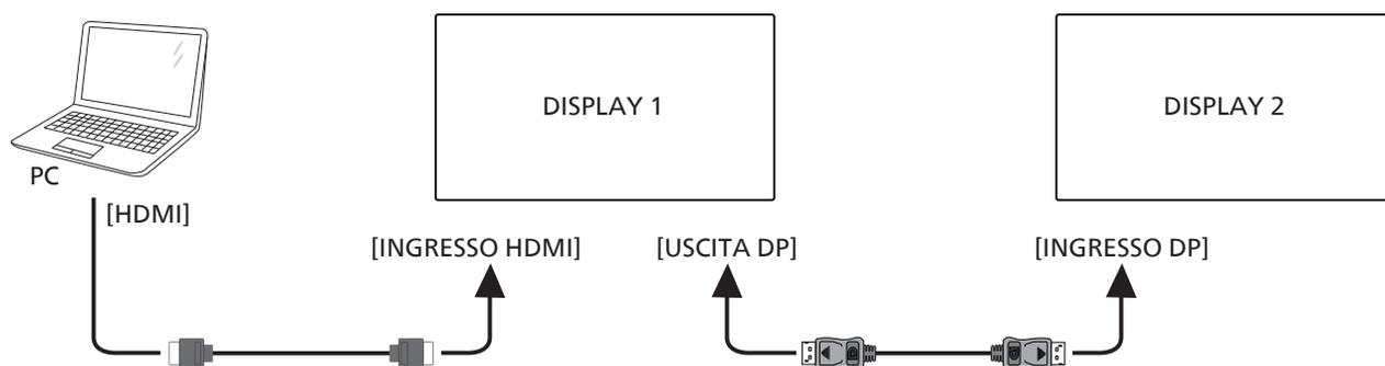
Collegare da [VGA] a [INGRESSO VGA] del laptop di DISPLAY 1, collegare il connettore [USCITA DP] di DISPLAY 1 al connettore [INGRESSO DP] di DISPLAY 2.
