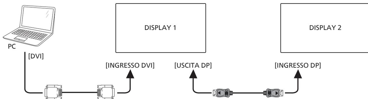
Collegare da [HDMI] a [INGRESSO HDMI] del laptop di DISPLAY 1, collegare il connettore [USCITA DP] di DISPLAY 1 al connettore [INGRESSO DP] di DISPLAY 2.
