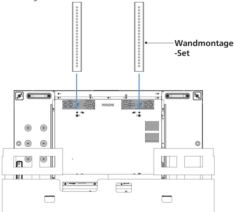
(9). Montieren Sie das Display an der Wand.
