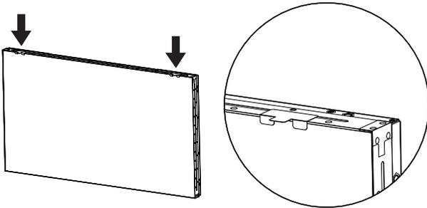
3. Installieren Sie das obere Display vorsichtig. Achten Sie nach Montage der Displays darauf, genügend Platz zwischen den Displays zu lassen, damit sich das Abstandspolster entfernen lässt. Falls sich das Polster nur schwer lösen lässt, passen Sie die Position des Displays so an, dass genügend Platz vorhanden ist.
