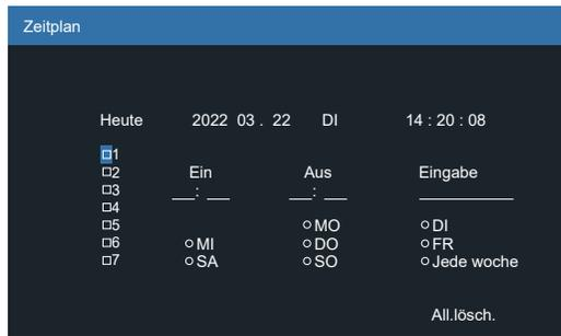
2. Wählen Sie mit  $\left[ \uparrow \right]$  oder  $\left[ \downarrow \right]$  ein Zeitplanelement (Elementnummer 1 – 7) und drücken Sie zum Markieren  $\left[ \text{OK} \right]$ .
