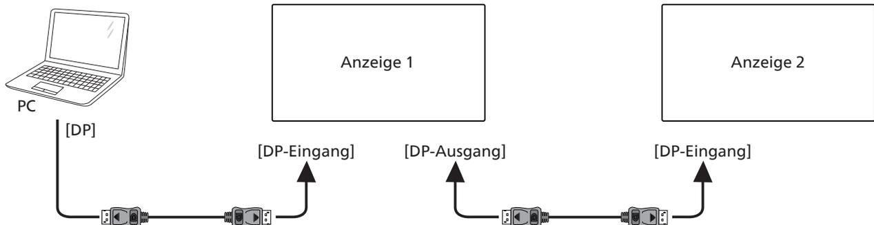
Verbinden Sie den [DVI]-Anschluss des Laptops mit dem [DVI-Eingang]-Anschluss an Anzeigegerät 1, verbinden Sie den Anschluss [DP-Ausgang] von Anzeigegerät 1 mit dem [DP-Eingang]-Anschluss von Anzeigegerät 2.
