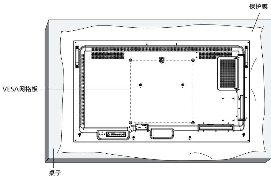
1. 将在平坦表面上包装显示器时在其周围包裹的保护膜展开。将显示器面朝下放在保护膜上，以便于操作而不会刮伤屏幕。
