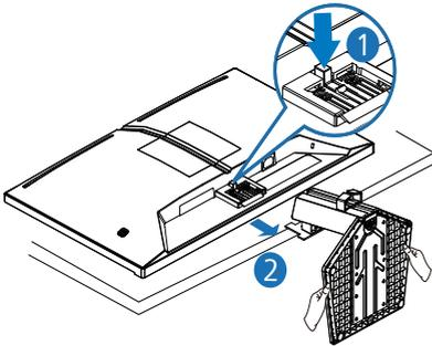
3. Presione ambas esquinas de la cubierta VESA y el otro lado de la cubierta asomará.
