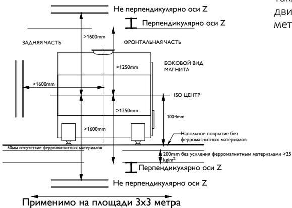
Не допускается расположение вблизи процедурной МРТ значительных масс металла, трансформаторов, электроустройств значительной мощности, лифтов, электрокабелей. Также, нежелательное влияние могут оказывать автомобили, трамваи и т.п., движущиеся в непосредственной близости от кабинета МРТ. Конструкционные металлические балки должны располагаться не ближе 2,5 м от центра аппарата.
