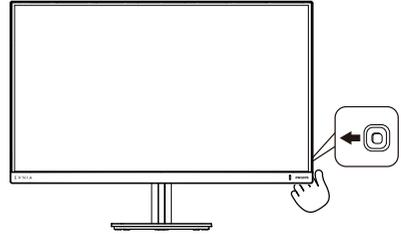
1. Deslice el botón de encendido hacia la izquierda para iniciar el menú de visualización en pantalla de SmartImage.
