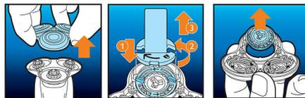
1. Puxe o suporte da cabeça de corte para fora. 2. Substitua as cabeças de corte por novas. 3. Recoloque o suporte da cabeça de corte. 4. Para
