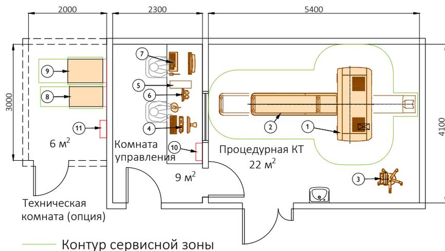
На плане указаны габариты помещений, рекомендуемые производителем оборудования.
