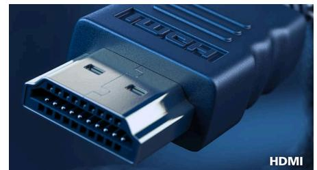
Ein HDMI ready-Gerät verfügt über sämtliche Hardware für den Empfang von HDMI-Signalen (High-Definition Multimedia Interface). Ein HDMI-Kabel ermöglicht hochwertige Audio- und Videosignale, die über ein einziges Kabel von einem PC oder anderen AV-Quellen (z. B. von Set-Top-Boxen, DVD-Playern, A/V-Recvfern und Videokameras) übertragen werden.
