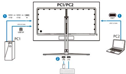
3. 進入 OSD 選單。移至 KVM 層並選擇「自動調整」，「USB C」或「USB Up」，將周邊設備的控制從一個裝置切換到另一個裝置。只需重複此步驟，即可使用一組周邊設備切換控制系統。KVM 自動調整：
