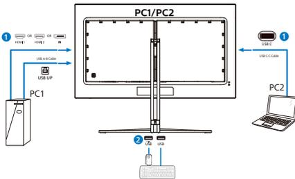
3. 進入 OSD 選單。移至 KVM 層並選擇「自動調整」，「USB C」或「USB Up」，將周邊設備的控制從一個裝置切換到另一個裝置。只需重複此步驟，即可使用一組周邊設備切換控制系統。KVM 自動調整：
