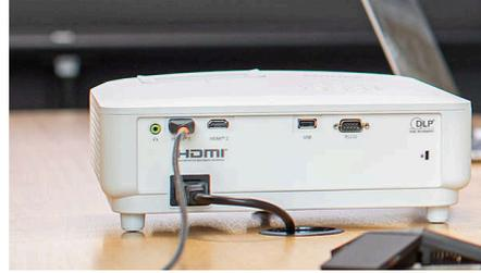
Le ProPix 850 dispose de deux entrées HDMI, pour une intégration fluide aux anciens systèmes couramment utilisés dans les institutions éducatives et les entreprises établies. Il inclut également un port RS232 pour les systèmes de contrôle audio vidéo professionnels, une connectivité USB et une sortie audio de 3,5 mm pour les systèmes audio externes.
