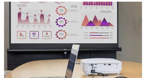
Entwickelt für vielseitige Installationsszenarien, mit beeindruckenden Bildern von 178 cm bis 380 cm (70" bis 150") Diagonale. Erstellen Sie mit einem Seitenverhältnis von 1,49:1 eine professionelle Anzeige mit einer Größe von 120 Zoll aus nur 4 Metern Entfernung. Das leichte Design mit 2,5 kg erleichtert den Transport und es werden mehrere Formate unterstützt (4:3/16:9/16:10/Native), sodass die Kompatibilität mit verschiedenen Inhaltsformaten gewährleistet wird.
