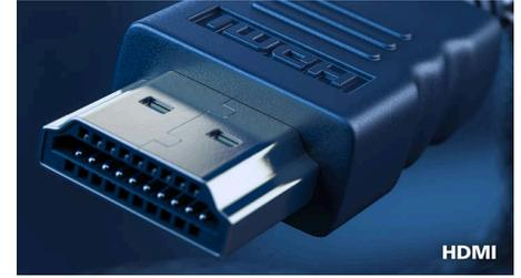
Un dispositivo compatible con HDMI tiene todo el hardware necesario para admitir una entrada de interfaz multimedia de alta definición (HDMI). Un cable HDMI permite transmitir audio y vídeo digitales de alta calidad a través de un solo cable desde un ordenador o desde fuentes AV (incluidos sintonizadores, reproductores de DVD, receptores de A/V y cámaras de vídeo).
