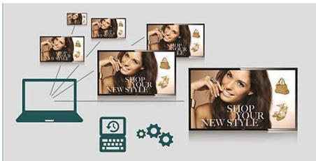
SmartControl te permite controlar de forma remota y gestionar tu red de pantallas a través de RJ45 y RS232C. Fácilmente sintoniza todos los ajustes de la pantalla, incluida la resolución, el brillo, el contraste y la clonación de los ajustes sobre la red completa.
