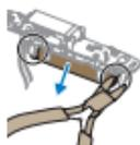
9. 充電電池ホルダーのツメをニッパーで切断し、充電電池を取り出します。
