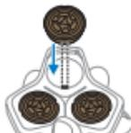
5. 保持板をシェービングヘッドに再度取り付け、時計回りに回します。
