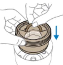
3. シールをつまみを持ち上げ、シールを端から引き上げてクイッククリーンポッドカートリッジから剥がします。
