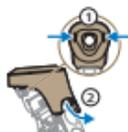
5. ハンドル上部カバーのツメを内側に押し(図①)、上部カバーをハンドル本体から取り外します(図②)。
