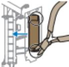
9. 充電電池ホルダーのツメをニッパーで切断し、充電電池を取り出します。
