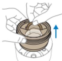
3. 新しいクイッククリーンポッドカートリッジをクイッククリーンポッドに装着します。
