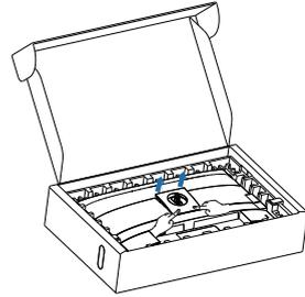
4. Lösen Sie die Montageschrauben, entfernen Sie das Scharnier.
