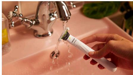
O OneBlade Íntimo agrada tanto a quem gosta de depilação a seco quanto aos que preferem a úmida, pois é totalmente à prova d'água, com certificação IPX7 (até 1 m de profundidade durante 30 minutos). Dessa forma, você pode se depilar como preferir, dentro e fora do banho. Depilar a seco também é possível, mesmo sem espuma de depilação. Enxágue o aparelho em água corrente após o uso para limpá-lo.
