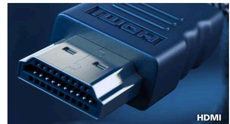
Ein HDMI ready-Gerät verfügt über sämtliche Hardware für den Empfang von HDMI-Signalen (High-Definition Multimedia Interface). Ein HDMI-Kabel ermöglicht hochwertige Audio- und Videosignale, die über ein einziges Kabel von einem PC oder anderen AV-Quellen (z. B. von Set-Top-Boxen, DVD-Playern, A/V-Receivern und Videokameras) übertragen werden.
