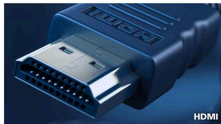
Un appareil compatible HDMI est équipé de l'ensemble du matériel requis pour accepter une source HDMI (High-Definition Multimedia Interface). Un seul câble HDMI suffit pour transmettre des signaux audio et vidéo numériques de haute qualité provenant d'un PC ou d'un large éventail de sources audio/vidéo (décodeurs, lecteurs de DVD, récepteurs audio/vidéo et caméscopes).
