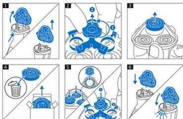
1. Abra o barbeador pressionando o botão de liberação; 2. Remova o retentor girando a trava no sentido anti-horário; 3. Retire as cabeças de
