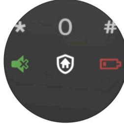
Antes de salir de casa, puede tocar el botón de bloqueo forzado exterior para activar la función. En este modo, abrir la puerta desde el interior activará una alerta. Esta función puede recordarle eficazmente los riesgos de seguridad y actualizar el nivel de seguridad del hogar.
