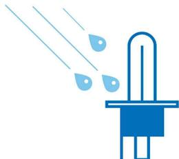
Только лампа из кварцевого стекла (нить накаливания 2650 °С, стекло 800 °С) может во включенном состоянии противостоять резким перепадам температуры — например, при попадании капли холодной воды на горячую лампу, если вы проедете по воде с поврежденным корпусом фары.
