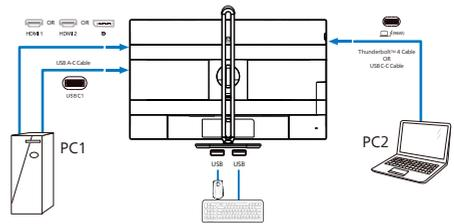
2. Acceda al menú de visualización en pantalla (OSD). Vaya a la pestaña KVM y seleccione “Auto (Automático)”, “Thunderbolt” o “USB C” para cambiar la vista del monitor de un dispositivo a otro. Para cambiar a otra vista de monitor, simplemente repita este paso.
