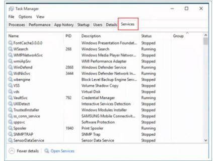
3. Faites défiler vers le bas et sélectionnez « WbioSrv » (le service biométrique de Windows). Si le statut indique « Running (En cours d'exécution) », cliquez avec le bouton droit pour arrêter le service en premier, puis redémarrez le service manuellement.
