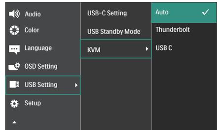
3. Allez dans l'onglet KVM et sélectionnez « Automatique », la fonction KVM Smart peut être utilisée.
