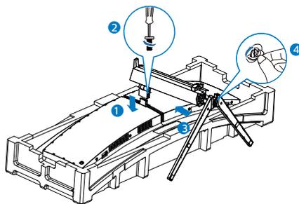
3. Po připevnění podstavce pevně uchopte monitor včetně fólie a postavte jej. Nyní můžete odstranit fólii. Při stahování fólie panel nesvírejte, aby se zabránilo jeho prasknutí.
