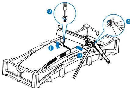
3. Dopo aver fissato la base, sollevare il monitor con entrambe le mani tenendo saldamente il monitor con il polistirolo. Ora è possibile estrarre il polistirolo. Quando si estrae il polistirolo, non schiacciare il pannello per evitare che si rompa.
