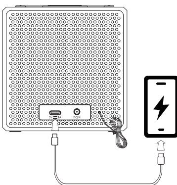
Povežite standardni kraj USB kabla (nije uključen) u USB Tip-C priključak na poleđini uređaja i povežite drugi kraj sa priključkom za punjenje na vašem uređaju.
