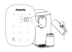
(4) 當"〈、"閃爍,產品發出"嘀嘀嘀"的提示音,將原 水箱的水倒掉,重新加自來水至Max線再放回。
