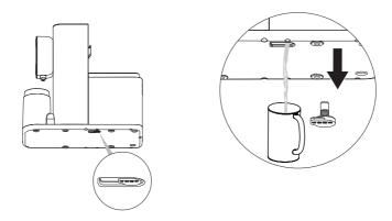
(4) 待再無水流出後, 請確保矽膠塞套回塞緊。放回原水箱、純淨水壺。
