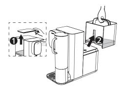
(2) 原水箱重新接滿水→放回原水箱→蓋好原水箱 蓋後→可進入正常使用。
