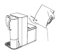
(2) 在原水箱注入半箱水,加入30克檸檬酸,攪拌融化後,浸泡2小時以上(單獨放置,不用放回機器)。
