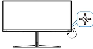
1. Deslice el botón de encendido hacia la izquierda para iniciar el menú de visualización en pantalla de SmartImage.
