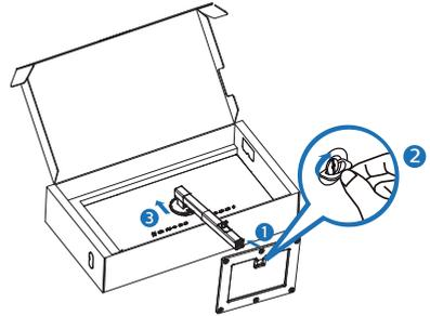
3. Halten Sie den Ständer nach der Installation mit beiden Händen und heben Sie den Monitor an.
