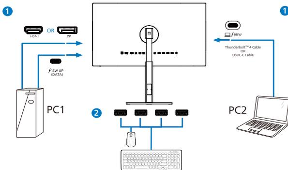
3. Rufen Sie das Bildschirrmeneü auf. Rufen Sie die KVM-Ebene auf und wählen Sie zum Wechseln der Peripheriesteuerung von einem Gerät zum anderen „Auto“, „Thunderbolt“ oder „USB up“ (USB-Upstream). Wiederholen Sie diesen Schritt einfach, wenn Sie das Steuersystem über ein Set Peripheriegeräte umschalten möchten.
