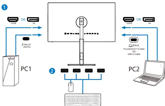
3. Rufen Sie das Bildschirmmenü auf. Rufen Sie die KVM-Ebene auf und wählen Sie zum Wechseln der Peripheriesteuerung von einem Gerät zum anderen „USB C“. Wiederholen Sie diesen Schritt einfach, wenn Sie das Steuersystem über ein Set Peripheriegeräte umschalten möchten.
