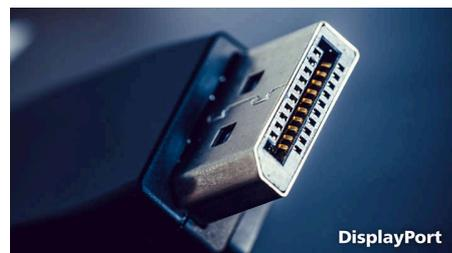
DisplayPort は、データを変換せずに PC からモニターへ転送するデジタルリンクです。DVI 基準よりも高い性能を持つこのポートは、最長 15 メートルのケーブルに対応し、最高 10.8 Gbps/秒のデータ転送を行うことができます。この高いパフォーマンスと無遅延により、最速のイメージングとリフレッシュレートを得られるため、一般的なオフィスや家庭での用途のほか、要求の厳しいゲームや映画、ビデオ編集などの用途の選択肢としても最適です。また、DisplayPort は、さまざまなアダプターの使用を通じた相互運用性も念頭に置いています。
