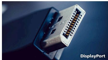
DisplayPort digitalna je veza između računala i monitora na kojoj ne dolazi do konverzija. Pruža veće mogućnosti od DVI standarda i u potpunosti podržava kabele duljine do 15 metara i brzinu prijenosa podataka od 10,8 Gb/s. Zahvaljujući iznimnim radnim značajkama i nultoj latenciji, moći ćete uživati u najbržim prikazima i najvećim brzinama osvježavanja — što DisplayPort vezu čini najboljim izborom za opću namjenu, ali i najboljim izborom za igre i
