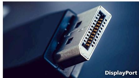
O DisplayPort é uma ligação digital entre o PC e o monitor, sem necessidade de conversões. Com capacidades superiores ao padrão DVI, é totalmente capaz de suportar até 15 metros de cabo e 10,8 Gbps/seg. de transferência de dados. Com este alto desempenho e sem atrasos, obtém as imagens e as taxas de atualização mais rápidas - tornando o DisplayPort na melhor escolha tanto para utilizar no escritório, como em casa, mas também para jogos e filmes exigentes, para a edição de vídeos e muito mais.
