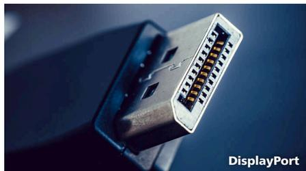
Интерфейс DisplayPort осуществляет прямую передачу цифровых сигналов с компьютера на монитор без преобразования. DisplayPort превосходит стандарт DVI и полностью поддерживает передачу данных с помощью 15-метрового кабеля со скоростью 10,8 Гбит/с.
