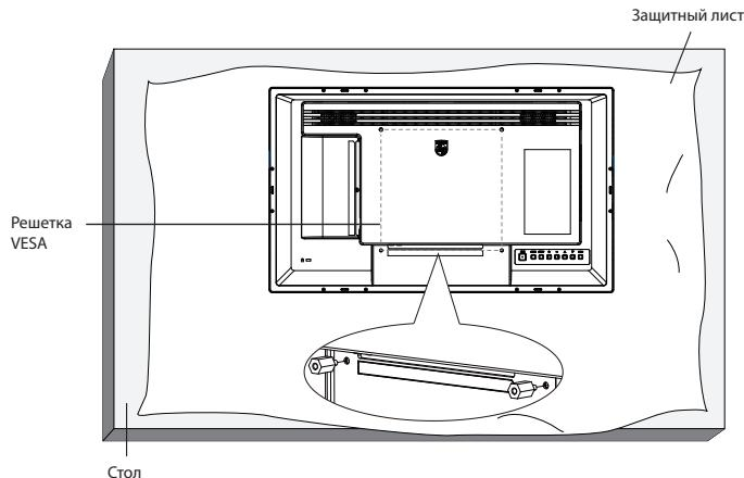
1. Подготовьте ровную горизонтальную поверхность размером больше монитора и застелите ее защитной пленкой, чтобы защитить поверхность экрана от царапин в процессе установки.
