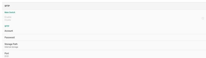
单击复选框以启用 / 禁用 SFTP 服务器功能。启用此功能后，用户可以设置帐户、密码和端口号。
