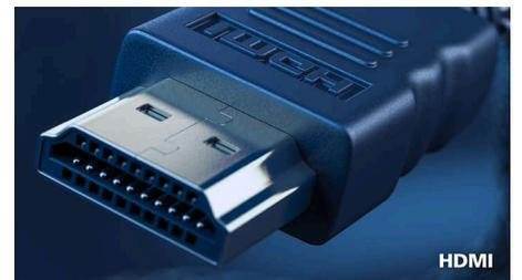
Un dispositivo compatible con HDMI tiene todo el hardware necesario para admitir una entrada de interfaz multimedia de alta definición (HDMI). Un cable HDMI permite transmitir audio y vídeo digitales de alta calidad a través de un solo cable desde un ordenador o desde fuentes AV (incluidos sintonizadores, reproductores de DVD, receptores de A/V y cámaras de vídeo).
