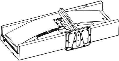
2. Відкрутіть монтажні гвинти, після чого від'єднайте ніжку від дисплея.
