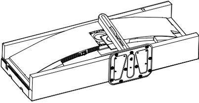
2. 松开组装螺丝，然后从显示器上拆下颈部。
