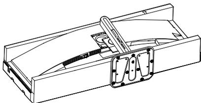
2. Открутите установочные винты, затем отсоедините ножку подставки от монитора.
