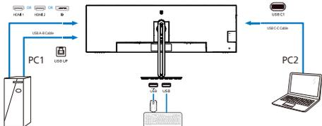
2. Откройте экранное меню. Откройте вкладку KVM и выберите Auto (Авто), USB C или USB up, чтобы переключить вид монитора с одного устройства на другое. Для переключения на другой вид монитора просто повторите это действие.
