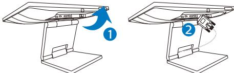
1. 將電源線穩固地連接至顯示器背面。
