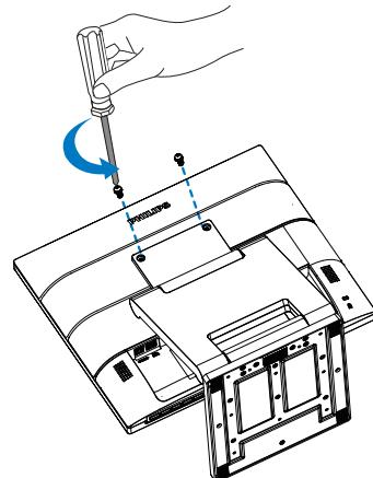
2. 將底座移入圖示位置。然後利用螺絲起子取下螺絲，接著將底座從顯示器拆卸。
