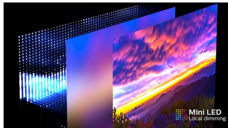
迷你 LED 背光改善照明控制和對比度。纖巧的迷你 LED 背光可構成 1152 個獨立控制分區，從而塑造更深沉的黑色和更明亮的白色，為豐富的 HDR 內容帶來無與倫比的對比度，影像得以準確呈現眼前。
