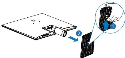
3. Pro odpojení sloupku podstavce stiskněte uvolňovací tlačítko.
