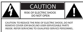
Ova „munja“ ukazuje na neizolovan materijal unutar uređaja koji može da izazove strujni udar. Zbog bezbednosti svih u vašem domaćinstvu, ne skidajte poklopac.
